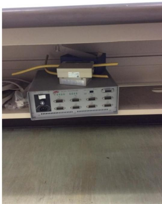
イーサネットケーブルの先にコンピュータをシリアル接続する装置
